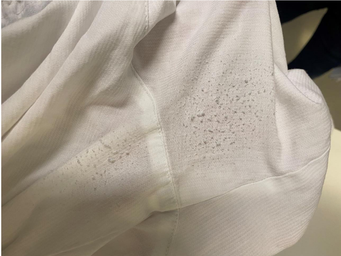
Figur 4. Vårdbyxa (artn. 70171-99) på Bollnäs Sjukhus som närmar sig slutet på sin livslängd till följd av materialslitage i grenen.
